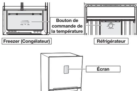
Il est recommandé de régler le contrôleur de température du congélateur et du réfrigérateur sur **Normal** pour un fonctionnement stable de l'appareil.
