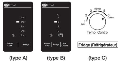
Si les aliments dans le réfrigérateur ne sont pas aussi frais que ce que vous souhaiteriez ou si vous désirez diminuer la température du réfrigérateur, réglez le contrôleur de température du réfrigérateur sur 5~6 ou sur 1 dans le cas d'un modèle avec affichage. Si les aliments dans le réfrigérateur sont gelés ou si vous désirez augmenter la température du congélateur, réglez le contrôleur de température du réfrigérateur sur 1~3 ou sur 3~7 dans le cas d'un modèle avec affichage.
