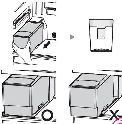
**ATTENTION** Fixez le réservoir d'eau sur la clayette à l'intérieur du réfrigérateur. Mal positionné, le réservoir d'eau pourrait ne pas fonctionner correctement. N'utilisez pas le réfrigérateur sans avoir préalablement installé le réservoir d'eau. Vous risqueriez d'en altérer l'efficacité. Lorsque vous mettez en place le réservoir d'eau, faites attention à ne pas vous coincer les doigts.
