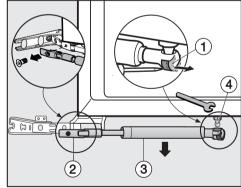
À l'aide d'un tournevis, poussez avec précaution le ressort de tension ① vers l'extérieur.
