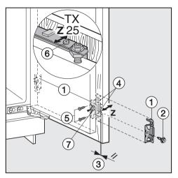
■ Placez l'équerre de fixation ① à l'aide de la vis à tête hexagonale ② sur les trous préforés de la porte de l'appareil.
