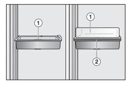
Il est constitué d'un bac profond ① et d'un bac plat ②, qui peuvent tous les deux être installés dans le cadre de support en inox.
