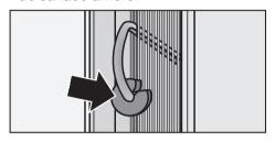
Ne démontez en aucun cas les écarteurs de la face arrière de l'appareil. Ceux-ci garantissent que l'espace libre entre l'arrière de l'appareil et le mur est suffisant.
