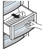
2. Lorsqu'il est impossible de tirer davantage le compartiment fraîcheur, levez-le légèrement et tirez-le complètement vers l'avant (vers l'extérieur).
