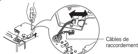
2) Enlevez l'arrêt en le faisant tourner dans le sens des aiguilles d'une montre (①) puis enlevez la charnière supérieure en la soulevant (②).
