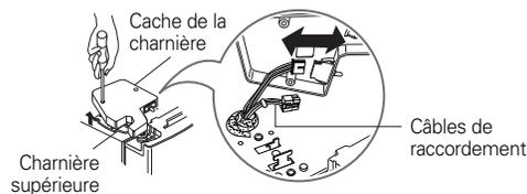
2) Enlevez l'arrêt en le faisant tourner dans le sens contraire des aiguilles d'une montre (①) puis soulevez la charnière supérieure (②).
