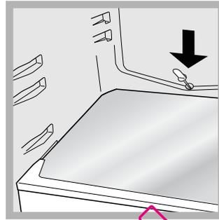
De koelkast is voorzien van een automatische ontdooifunctie: het water wordt door een speciale afvoeropening (zie afbeelding) naar de achterkant geleid waar de warmte van de compressor het doet verdampen.
