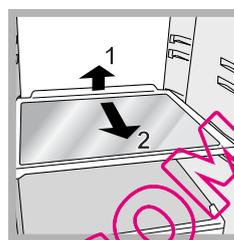
**RIPIANI:** pieni o a griglia. Sono estraibili e regolabili in altezza grazie alle apposite guide (vedi *figura*), per l'inserimento di contenitori o alimenti di notevole dimensione. Per regolare l'altezza non è necessario
