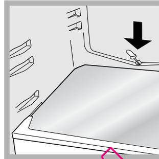
El frigorífico posee descongelación automática: el agua se envía hacia la parte posterior por un orificio de descarga (*ver la figura*) donde el calor producido por el compresor la hace evaporar. La única
