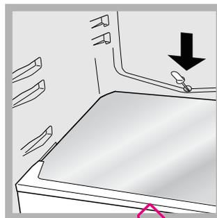
Il frigorifero è dotato di sbrinamento automatico: l'acqua viene convogliata verso la parte posteriore da un apposito foro di scarico (*vedi figura*) dove il calore prodotto dal compressore la fa evaporare. L'unico intervento da fare
