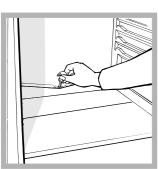
za pomocą odpowiedniego otworu (patrz rysunek), gdzie ciepło wytworzone przez sprężarkę powoduje jej odparowanie. Jedyną czynnością jaką należy wykonać co jakiś czas, to wyczyszczenie otworu odpływowego tak, aby woda mogła swobodnie wyciekać.
