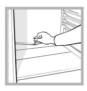
Hladilnik je opremljen s samodejnim odtajanjem: voda se steka proti zadnji steni k ustrezni odtočni odprtini (*glej sliko*), kjer izpari zaradi toplote, ki jo proizvaja kompresor. Edino kar morate storiti je, da občasno očistite odtočno odprtino, da
