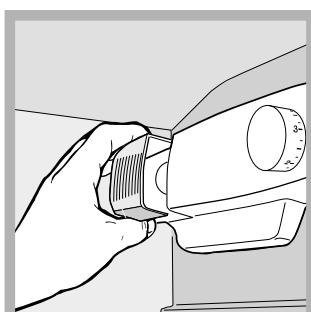
Acceda a la lámpara quitando la protección como se indica en la figura. Sustítuyala con otra bombilla con una potencia igual a la indicada en la protección (15 W o 25 W).
