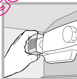
Öffnen Sie die Lampenabdeckung wie auf der Abbildung veranschaulicht. Ersetzen Sie die Lampe durch eine neue derselben Leistung und Bauform (auf der Schutzabdeckung angegeben)(15 W oder 25 W).
