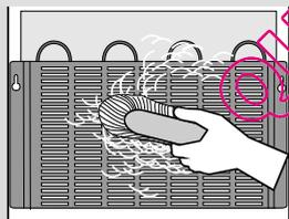
**Le condenseur** placé sur la paroi arrière doit toujours être propre, exempt de poussière et de dépôts gras. Dépoussiérez-le régulièrement avec une brosse non métallique ou un aspirateur.
