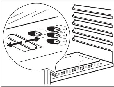
La clayette inférieure en verre est équipée d'un dispositif muni de fentes dont les ouvertures sont réglables à l'aide d'un levier coulissant, afin de réguler la température du bac à légumes.
