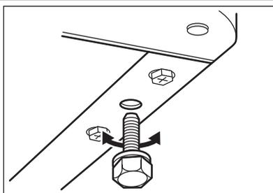
Lorsque vous installez l'appareil, veillez à le placer de niveau. Servez-vous des deux pieds réglables se trouvant à l'avant de l'appareil.
