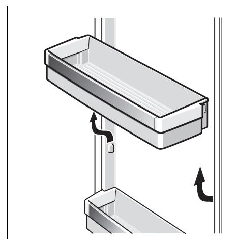
Полку можно приподнять и снять с двери.
