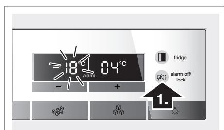
Il display temperatura indica per 10 secondi la temperatura più alta raggiunta nel congelatore. Dopo viene di nuovo visualizzata la temperatura regolata.
