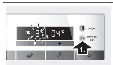
В течение 10 секунд дисплей показывает самую высокую температуру, которая устанавливалась в морозильном отделении. После чего на дисплей снова выводится заданная температура.
