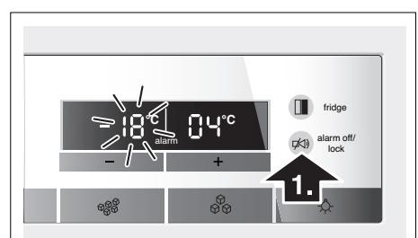
Die Temperaturanzeige zeigt für 10 Sekunden die wärmste Temperatur an, die im Gefrierraum geherrscht hat. Danach wird wieder die eingestellte Temperatur angezeigt.
