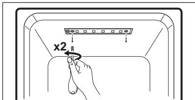
3. Staccare il cablaggio della piastra LED e sostituire i LED.
