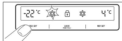
Zum Einstellen der Temperatur die Taste **FRZ. SET** drücken, bis die gewünschte Temperatur angezeigt wird.
