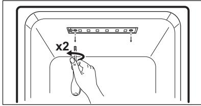
3. Koppel de LED van de LED-plaat los en vervang de LED.
