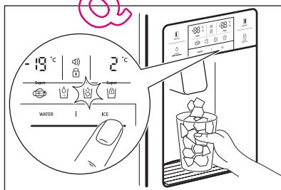
Wanneer u het ijsblokjessysteem reinigt of wanneer u het voor lange tijd niet gebruikt, verwijder de ijsblokjes uit de bewaarbak en vergrendel de ijsmaker door gedurende 3 seconden op de toets ICE te drukken. De
