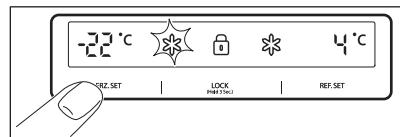
Για τη ρύθμιση της θερμοκρασίας, πατήστε το πλήκτρο **FRZ.SET**, μέχρι να προβληθεί η θερμοκρασία που επιθυμείτε.
