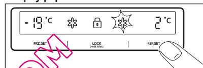
Για τη ρύθμιση της θερμοκρασίας, πατήστε το πλήκτρο **REF.SET**, μέχρι να προβληθεί η θερμοκρασία που επιθυμείτε.
