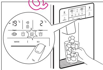
Bei der Reinigung des Eiswürfelfaches oder wenn Sie es längere Zeit nicht benutzt haben, entfernen Sie die Eiswürfel aus dem Eiswürfel-Vorratsbehälter und verriegeln Sie den Eisbereiter, indem Sie die Taste ICE 3 Sekunden lang gedrückt halten. Die Anzeige leuchtet auf.
