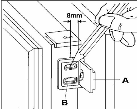
9. Afin d'aligner la porte de la cuisine, aidez vous de l'ajustement des encoches. A la fin de l'opération, il est nécessaire de vérifier que la porte de la cuisine ferme correctement.
