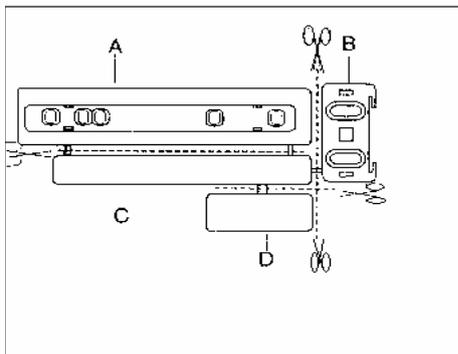
6. Placez la glissière (A) sur le côté intérieur de la porte de cuisine, aux distances indiquées dans le dessin ci-dessous, et marquez les positions des trous. Après avoir percé les trous, fixez la glissière avec les vis fournies.
