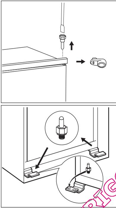
La porte de l'appareil s'ouvre vers la droite. Si vous souhaitez modifier le sens d'ouverture de la porte (vers la gauche), effectuez les opérations suivantes avant d'installer définitivement l'appareil :
