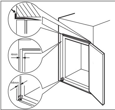
Ajustez la position de l'appareil dans le meuble d'encastrement. Assurez-vous que la distance entre l'appareil et le bord avant du meuble est de 44 mm.
