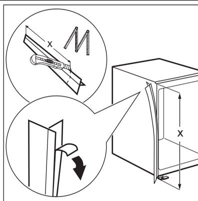
Si nécessaire, coupez la bande d'étanchéité adhésive et appliquez-la sur l'appareil, comme indiqué sur la figure.
