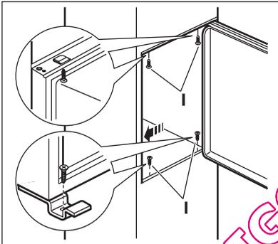
Fixez l'appareil au meuble d'encastrement à l'aide de 4 vis.
