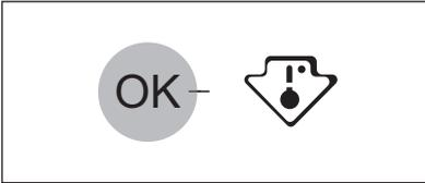
Pour vous aider à contrôler correctement votre appareil, nous avons intégré un indicateur de température à votre réfrigérateur. Le symbole sur le côté indique la zone la plus froide du réfrigérateur.
