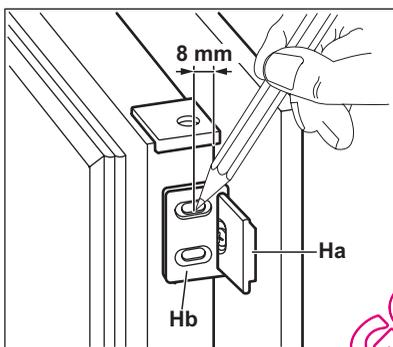
Ouvrez la porte de l'appareil et la porte du meuble de cuisine à un angle de 90 °C. Insérez le petit carré (Hb) dans le guide (Ha). Joignez la porte de l'appareil et la porte du meuble et repérez les trous.
