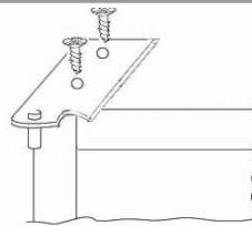
Quite la clavija de la parte izquierda e introduzcala en la parte derecha de la hendidura central e inferior.
