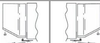
Entfernen Sie die mittlere Schraube und entfernen Sie die obere Tür.
