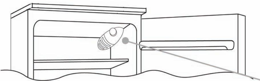
Termostatboksen som kontrollerer apparatet befinner seg opp til høyre i kjøledelen. For å kontrollere at apparatet virker, må du sjekke at termstatens bryter ikke står på „0“.
