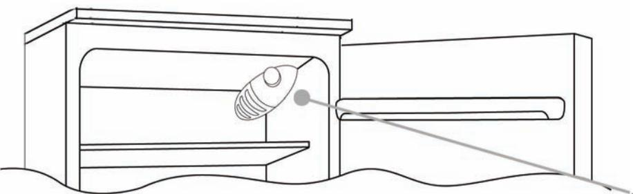
Die Thermostatbox zur Steuerung des Gerätes befindet sich oben rechts im Inneren des Kühlraums. Um zu prüfen, ob das Gerät in Betrieb ist, stellen Sie sicher, dass der Thermostatkopf nicht auf **ON** gestellt ist.
