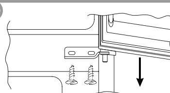
Entfernen Sie die Schutzkappen (A) und (B), lösen Sie die Schrauben und ziehen Sie die Stirnwand teilweise heraus.
