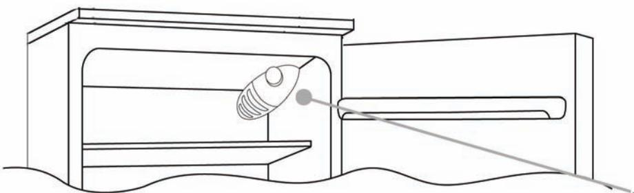
Le thermostat commandant l'appareil se trouve en haut à droite à l'intérieur du réfrigérateur. Pour vérifier que l'appareil fonctionne, assurez-vous que le bouton du thermostat ne se trouve pas en position **OFF**.
