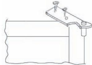
Ota vasen yläsarana laitteenvahtimasta välipakkauksesta ja aseta se paikalleen.
