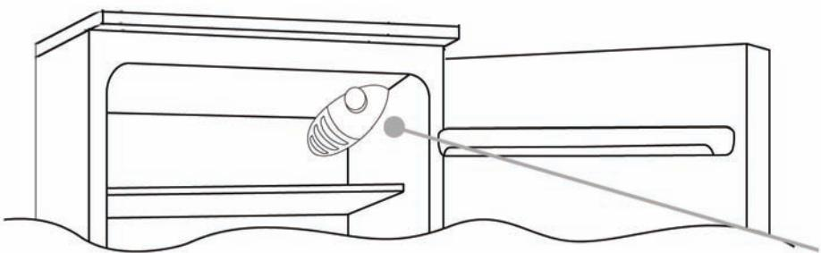
De thermostaatregelaar van het apparaat bevindt zich rechtsboven in het koelkastgedeelte. Om te controleren of het apparaat functioneert dient u erop te letten dat de knop van de thermostaat niet op „0“ staat.
