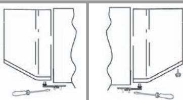
Avlägsna den mittersta skruven och avlägsna den övre dörren
