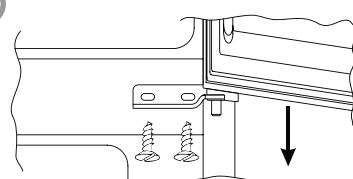
Avlägsna täckpluggarna (A) och (B), skruva loss skruvarna och avlägsna delvis panelen
