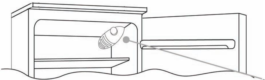
A caixa do termóstato que controla o equipamento está localizada dentro do compartimento do frigorífico no lado superior direito. Para verificar se o equipamento está a funcionar, certifique-se de que o botão do termostato não está regulado para „0“.
