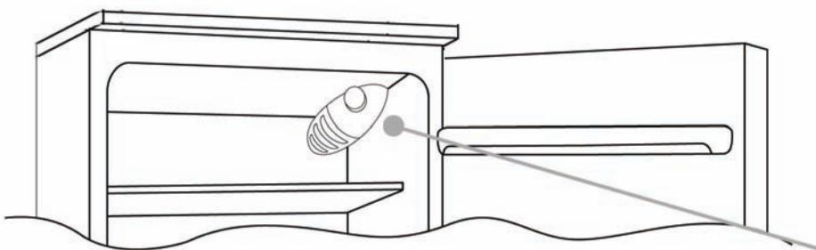
La caja del termostato que controla la aplicación se encuentra a ubicada dentro del compartimento del frigorífico en la zona superior derecha. Para comprobar si la aplicación está funcionando , asegúrese de que la rueda del termostato no esté fijada en "0".
