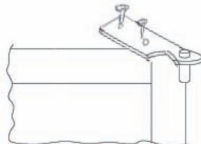
Τοποθετήστε τον πάνω αριστερό μεντεσέ που βρίσκεται στο κιτ των αξεσουάρ
