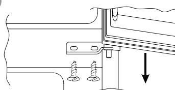
Retirez les caches (A) et (B), desserrez les vis et enlevez partiellement le bandeau.
