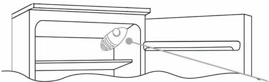
Laitteen säätöön tarkoitettu termostaattilaatikko sijaitsee jääräappiosaston sisällä oikealla ylhäällä. Kun haluat tarkastaa, että laite toimii, varmista, että termostaattinuppi ei ole asennossa "0".
