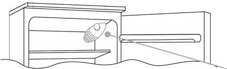
Το κουτί θερμοστάτη για τον έλεγχο της συσκευής βρίσκεται στο εσωτερικό του χώρου συντήρησης στο πάνω δεξιό μέρος. Για να ελέγξετε αν η συσκευή λειτουργεί, βεβαιωθείτε ότι το κουμπί του θερμοστάτη δεν έχει ρυθμιστεί στο „0“.
