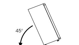
Saque la bisagra inferior, desatornillando las tuercas , sacando el enchufe y las arandelas y a continuación, saque la puerta inferior
