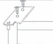
Αφαιρέστε την τάπα της αριστερής πλευράς και τοποθετήστε τη στη δεξιά πλευρά του κεντρικού και κατώτερου προσαρμογέα.
