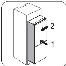
Installez l'appareil dans son emplacement. Poussez l'appareil en suivant les flèches (1) jusqu'à ce que la partie supérieure vienne toucher le mobilier de la cuisine. Poussez l'appareil dans le sens des flèches (2) contre le meuble, du côté opposé à la charnière.
