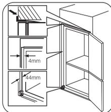
Calez l'appareil dans son emplacement. La distance entre l'appareil et le bord de la face avant du meuble doit être de 44 mm.
