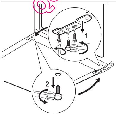
Dévissez les deux pieds réglables et les vis de la charnière de la porte inférieure. Retirez la charnière de la porte inférieure et montez-la de l'autre côté.
