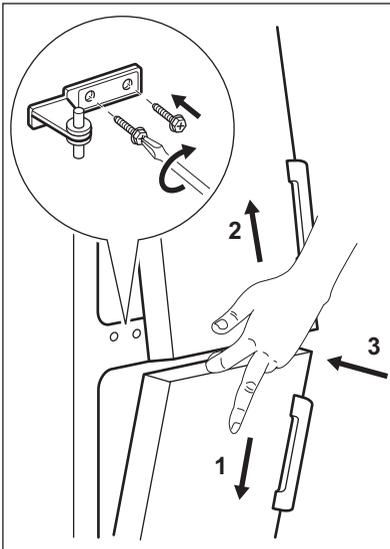
Enfilez les portes dans les pivots et installez-les. Mettez en place la charnière.
