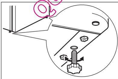
Lorsque vous installez l'appareil, veuillez à le placer de niveau. Servez-vous des deux pieds réglables se trouvant à l'avant de l'appareil.
