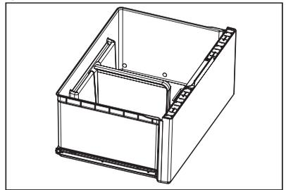
Pour contrôler l'humidité dans le bac à légumes, la clayette inférieure en verre est équipée d'un dispositif muni de fentes dont les ouvertures sont réglables à l'aide d'un levier coulissant.
