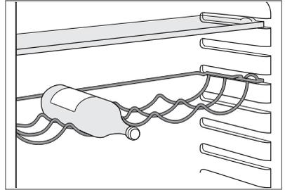
Cette clayette peut être inclinée afin de pouvoir y placer des bouteilles déjà ouvertes. Pour cela, tirez la clayette vers le haut afin qu'elle puisse glisser vers le haut et être placée sur le niveau supérieur.
