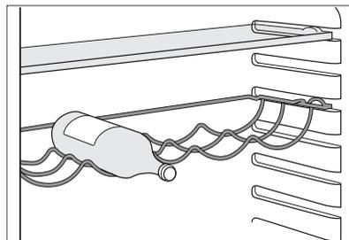
Il ripiano può essere inclinato per consentire l'appoggio di bottiglie già aperte. Per inclinarlo, tirare verso di sé il ripiano e ruotarlo verso l'alto, in modo da appoggiarlo sul livello immediatamente superiore.
